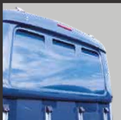
GRP wind flap with integrated third brake light (optional) for Balios®, Xanthos®, Zephir® and Maximus® Coupe-vent GFK avec troisième feu stop intégré (en option) pour Balios®, Xanthos®, Zephir® et Maximus® GVK-windklep met geïntegreerd derde remlicht (optioneel) voor Balios®, Xanthos®, Zephir® en Maximus®
